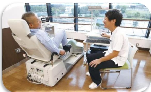
背もたれつきシートのため、自力で座れなくても足の筋力測定が可能です。さらに、アシスト機能が付き能力に合った負荷量に調整できます。
